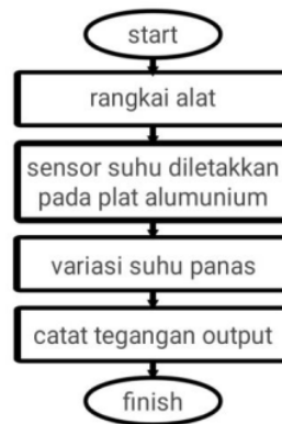
Gambar 3. flowcart generator termoelektrik
