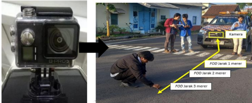
Gambar 4. Teknik pengambilan sampel di landasan bandara Blimbingsari dengan Action Cam
