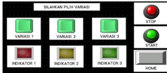
Gambar 2 Tampilan modul HMI pada pengupas kelapa muda
