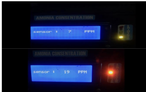
Gambar 5. Hasil Uji Coba Lampu Indikator Alat
