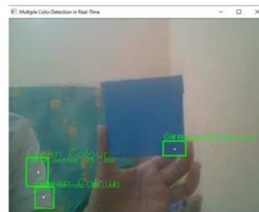
Gambar 6. Deteksi Warna Hijau pada Objek Biru dengan Latar Beragam
